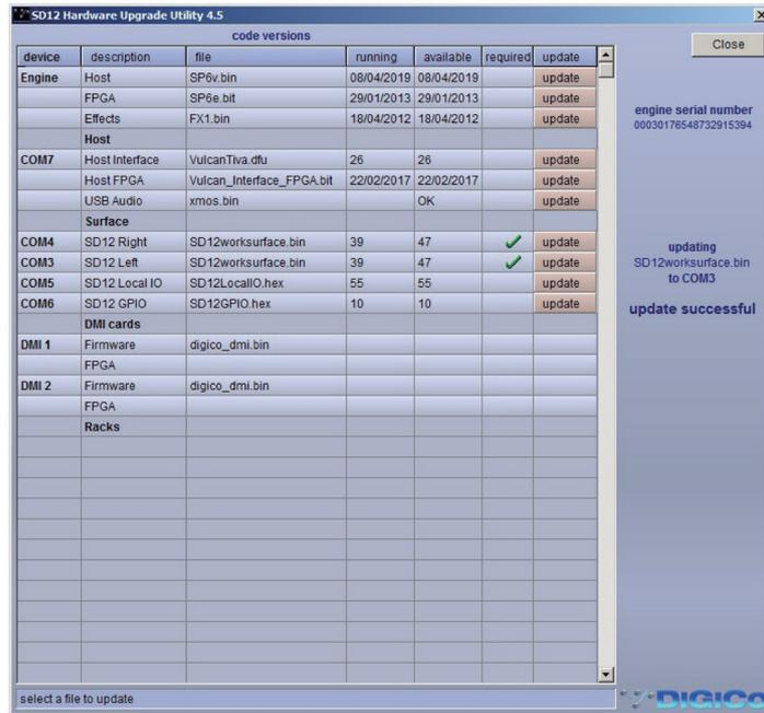
Hardware Upgrade Utility アプリケーションを閉じてからもう一度開くと、アプリケーションウィンドウは下図のように、worksurface の” Running” コードが表示されていない状態で立ち上がります。ここまでを確認したら次の手順に進みます。
